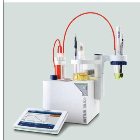
Titration Excellence significa modularidad al máximo nivel. El sistema se puede adaptar para satisfacer las necesidades cambiantes de su laboratorio. La determinación del índice de bromo, cloruros en petróleo crudo o los análisis coulométricos de Karl-Fischer son solo algunos ejemplos de la potencia de aplicación del sistema.
