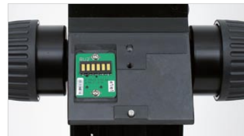
Contactos de la codificación interna de los dispositivos
