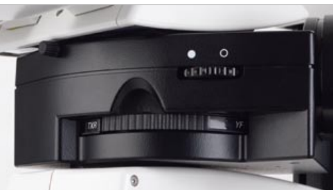
Módulo de fluorescencia del Leica M165 FC
