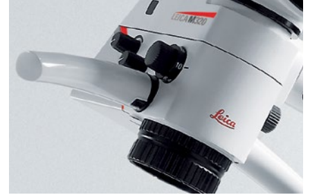
Las asas se pueden desmontar y esterilizar
