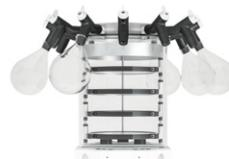
Cámara acrílica con 12 colectores superiores y estantes para el secado a granel, viales y matraces
